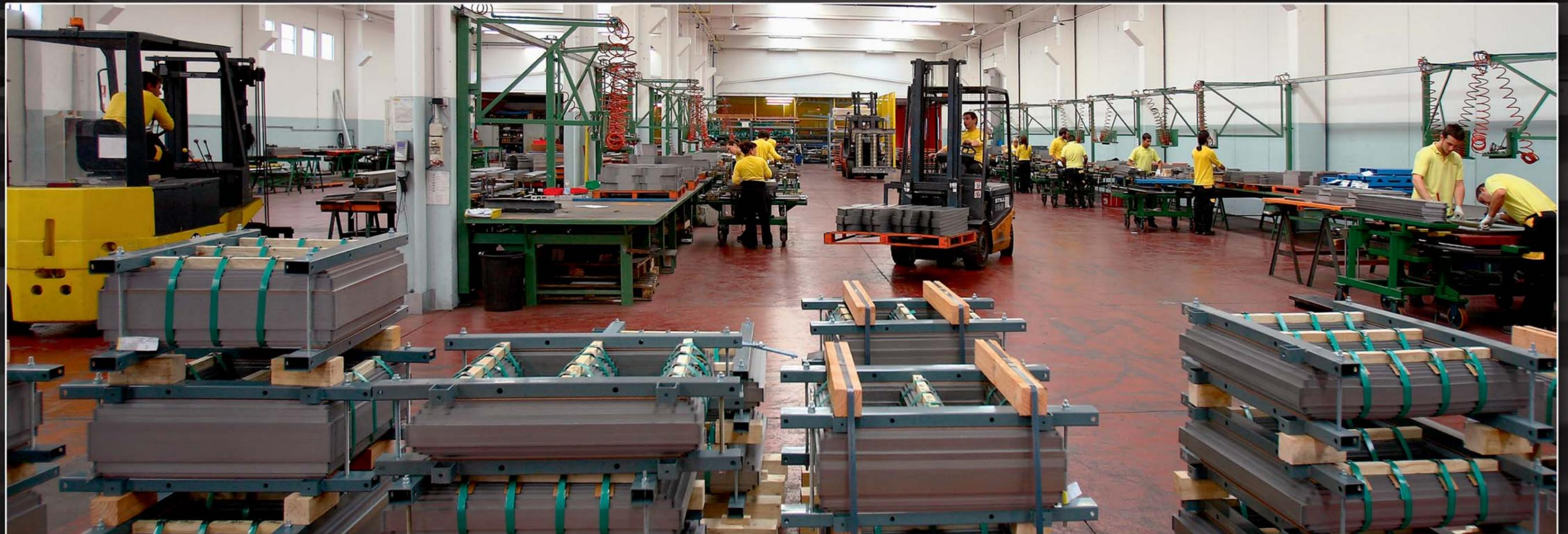
Un esempio di questa attenzione totale alla qualità dei dettagli sono i banchi di montaggio ad alta precisione, che sono progettati e costruiti da Euronuma, e dove il personale altamente specializzato assembla i lamierini magnetici.
