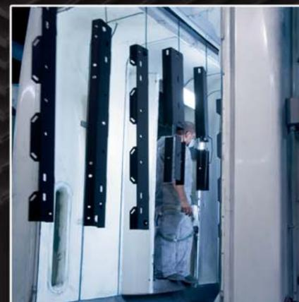
Per la verniciatura viene utilizzata la resina bicomponente, che ha il vantaggio di diminuire la rumorosità di funzionamento e migliorare l'isolamento.
