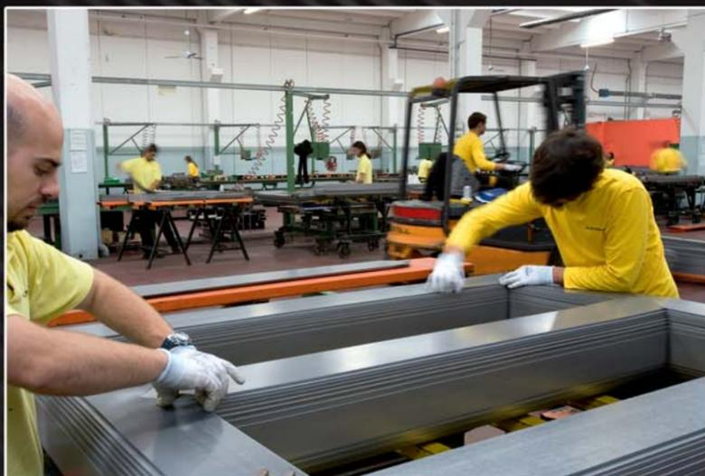
I nuclei magnetici possono essere rifiniti su disegno del cliente con le armature di sostegno e pressaggio, con la predisposizione dei materiali isolanti e delle tiranterie necessarie. Euronuma si occupa direttamente di tutte le opere di carpenteria: un'altra garanzia insostituibile di sicurezza, di velocità e di qualità.
